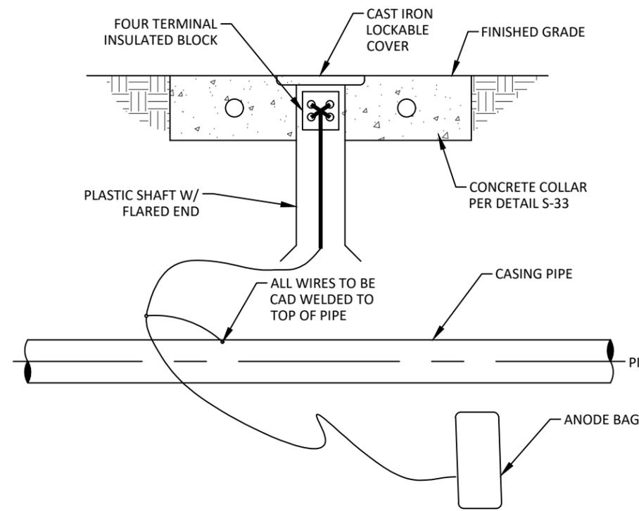
**CATHODIC TEST STATION DETAIL**
